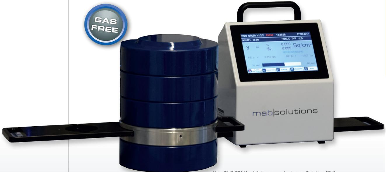
Abb.: RMS STC60 mit internem und externen Detektor SZ60, sowie 50mm Bleiabschirmung
